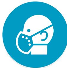
**Protección respiratoria.** Los trabajadores afectados a tareas en ambientes con gases, vapores, humos, nieblas, polvos, fibras, aerosoles, deben utilizar obligatoriamente un equipo de protección respiratoria.
